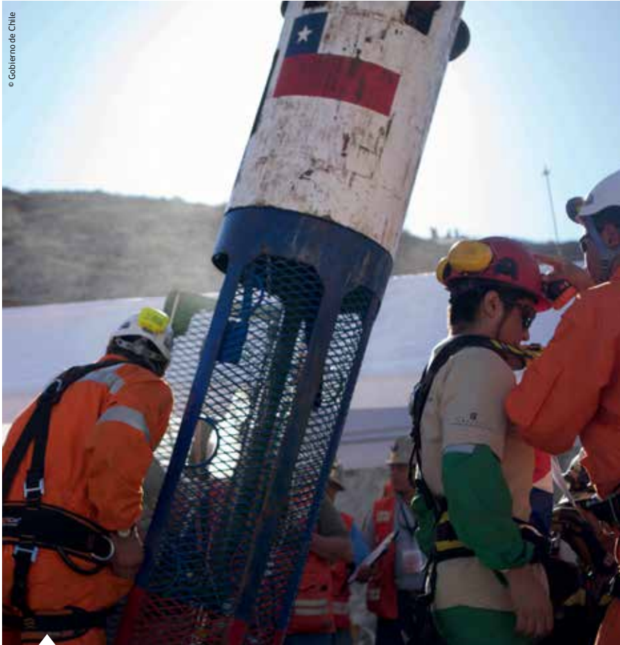
La cápsula Fénix, con que fueron rescatados los mineros, fue fabricada en los Astilleros de Asmar. Tiene 3,98 metros de longitud y 54 centímetros de diámetro.
